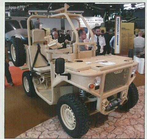
Stále více firem nabízí specializovaná lehká terénní vozidla, jejichž velmi malé vnější rozměry umožňují přepravu uvnitř kabín větších transportních vrtulníků. Jednou z nich je i francouzská firma UNAC, která na výstavě Eurosatory představila prototyp vozidla Fardier, jež je pouze 2,6 m dlouhé, 1,6 m široké a 1,9 m vysoké. Pohání jej motor Kohler KDW1404 o výkonu 26 kW a vozidlo má vlastní hmotnost 1000 kg, respektive až 1900 kg maximální povolenou.
